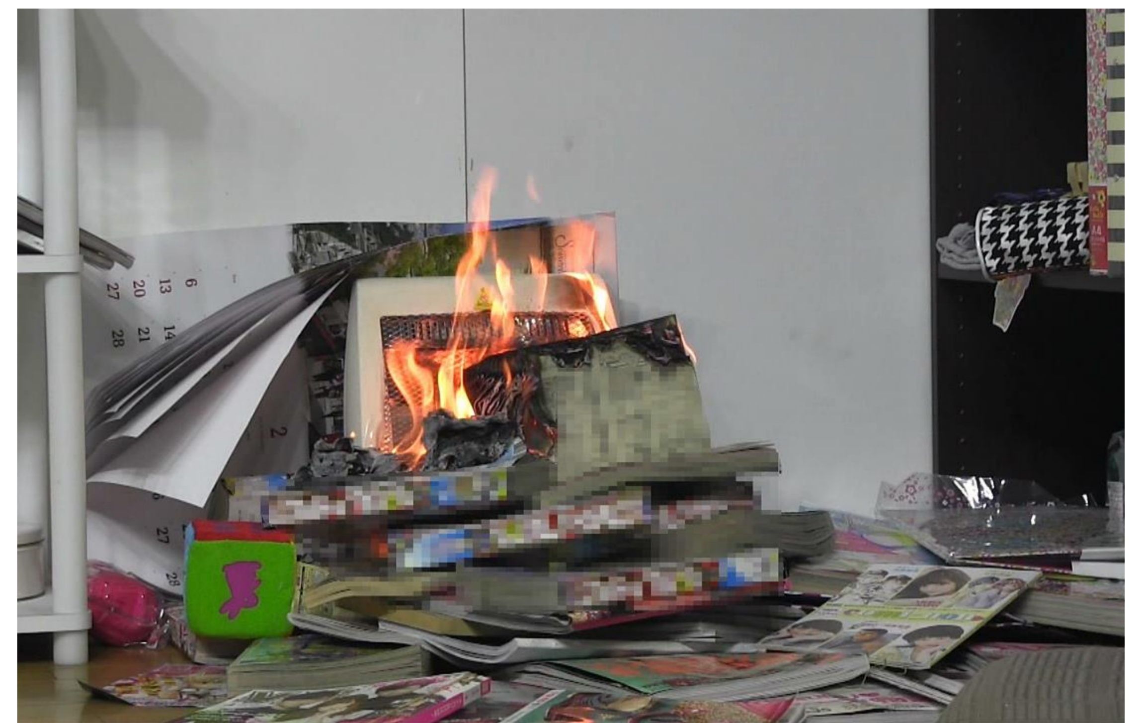
揺れによって可燃物が電気ストーブの周囲に落下して、可燃物に着火した事故の再現実験
